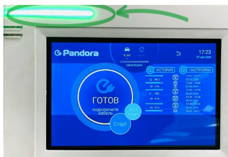
Светодиодный индикатор режима работы станции
